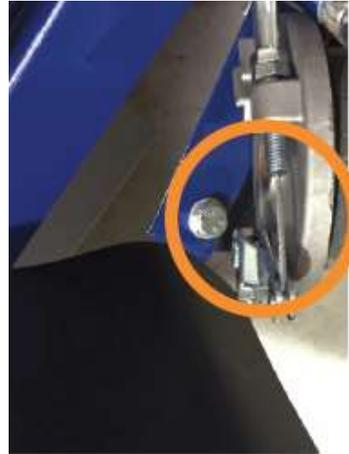
NOTA: Si tiene dificultades para conectar el cable de freno al disco de freno, es posible que deba aflojar el freno. En la palanca del freno, desenrosque el perno de conexión para aflojar el cable y que alcance. Siga los siguientes pasos para fijar la rueda ANTES de volver a apretar este perno.
