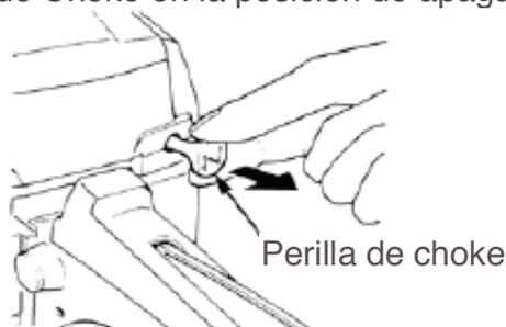
**Nota:** Cuando reinicie inmediatamente después de detener el motor, deje la perilla de choke en posición abierta.
