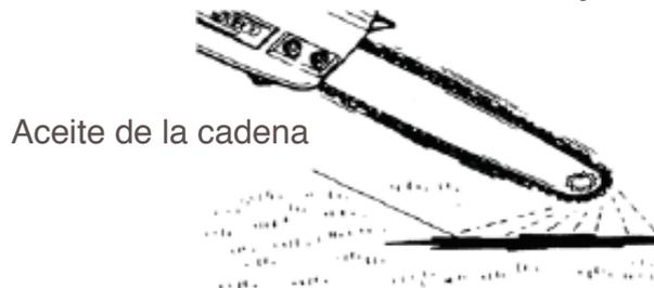
El flujo de aceite de cadena puede ser cambiado insertando un destornillador en el orificio al lado del embrague. Ajuste dependiendo de las condiciones de trabajo.
