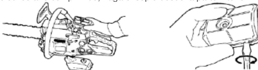
**NOTA:** Cuando instale el filtro principal, asegúrese que los surcos en el borde del filtro estén correctamente ajustados con las proyecciones en la cubierta del cilindro.
